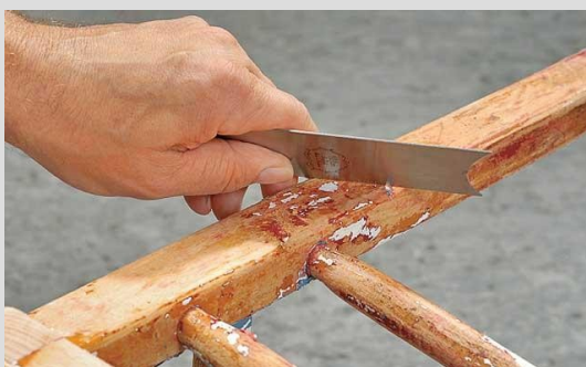
Ziehklinge Tynd stålplade, hvis kant er forsynet med en grat, og som føres skråt hen over en høvlet flade for at udslette høvlstrøgene.
